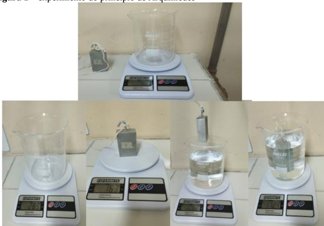
Figura 1 – experimento do princípio de Arquimedes
