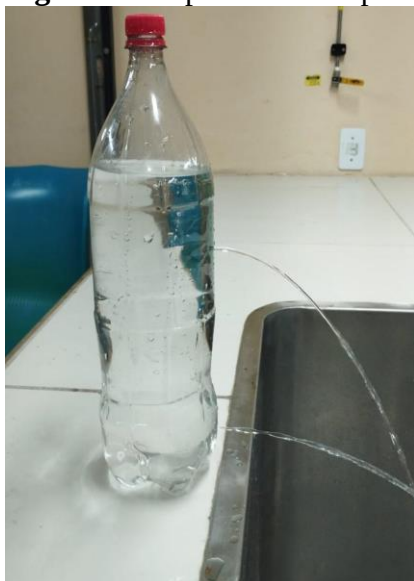
Figura 7 – experimento da pressão hidrostática e atmosférica
